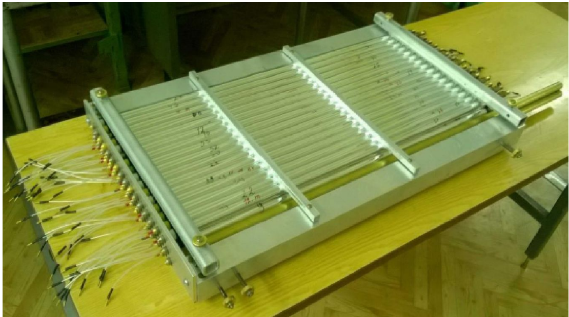
Рис. 16. Фотография блока дрейфовых трубок в сборочном стапеле.
