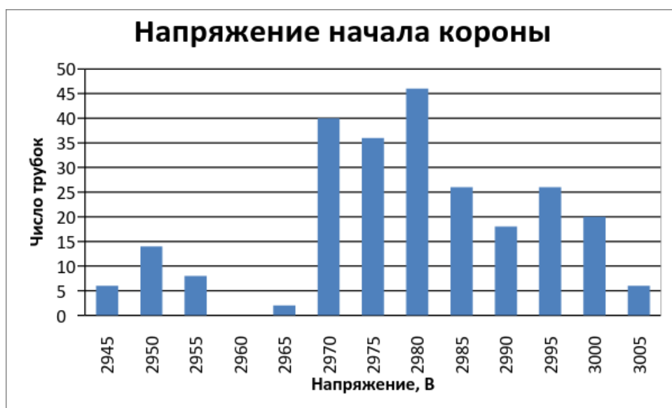
Рис. 15. Напряжение начала коронного разряда
