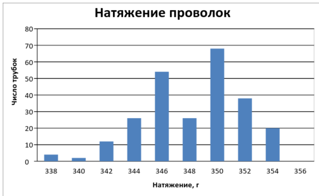
Рис. 7. Натяжение проволоки в трубках.
