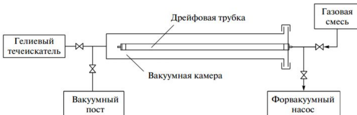
Рис. 11. Схема стенда проверки герметичности дрейфовой трубки
