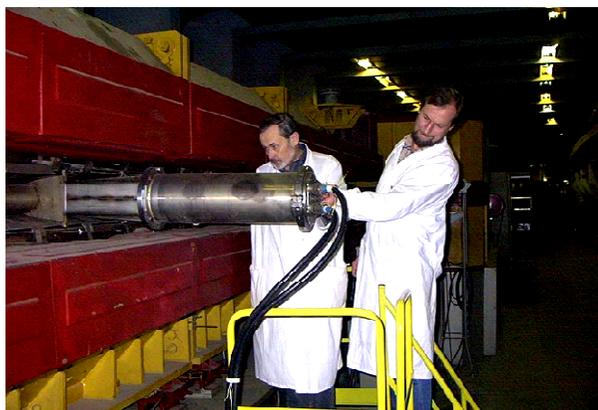
Установка выводного блока в вакуумную камеру ускорителя
