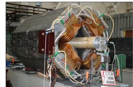
Магнитная линза – основной элемент формирования пучка протонов
