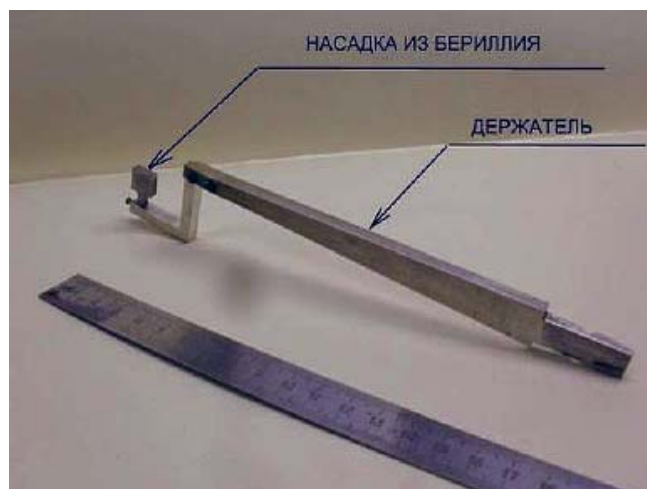
Рис. 3.2.1.4 Бериллиевая насадка для мишени Пиччиони
