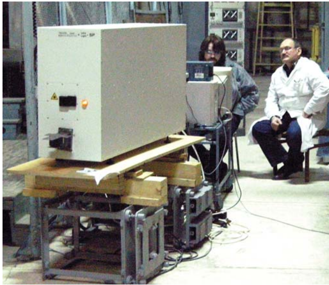
Рис 2.3.2. Одномодульный вариант лазера InfraLight SP с энергией до 2 Дж, 2008 год
