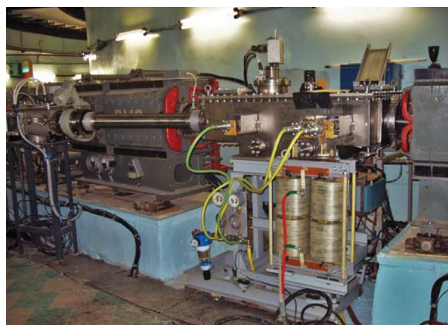
Рис. 2.5.3. Смонтированный на кольце У-1,5 септум-магнит
