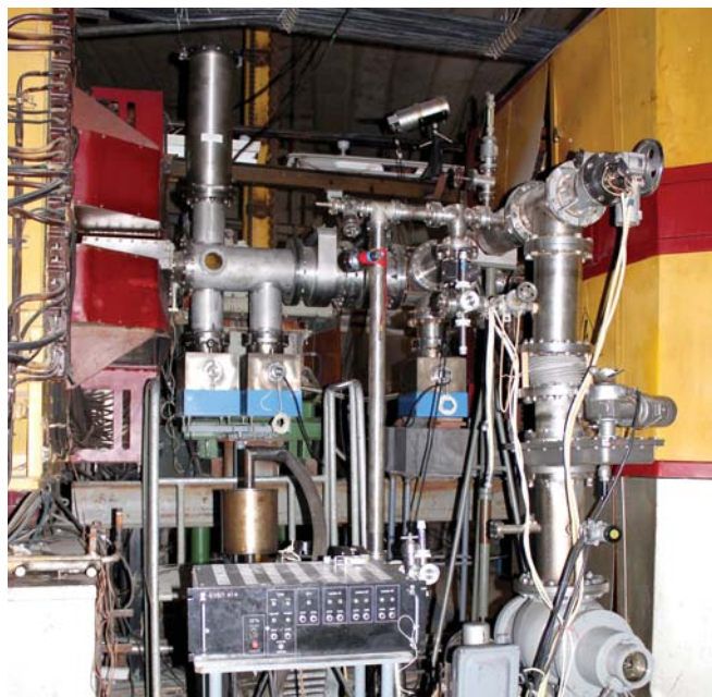
Рис 3.2.1.1. Вид 28-го промежулка ускорителя У-70 с мишенью Пиччиони и вакуумным оборудованием
