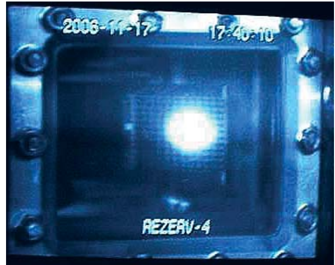
Рис 2.4.7. Телевизионный кадр с сцинтилляционной станции наблюдения пучка в конце канала перевода (ноябрь 2006 года)
