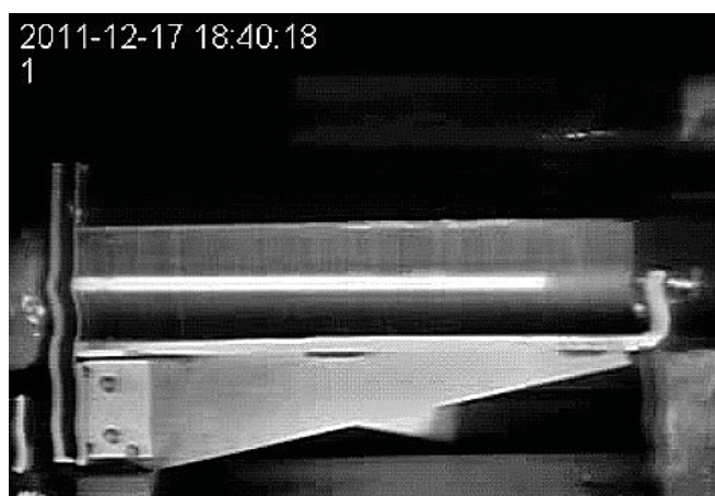
Рис. 4.1. Прохождение пучка ядер углерода, выведенных из ускорителя У-70, через пластический сцинтиллятор. Пробег пучка в сцинтилляторе \approx 32 см. Картинка получена в экрана ТВ монитора.
