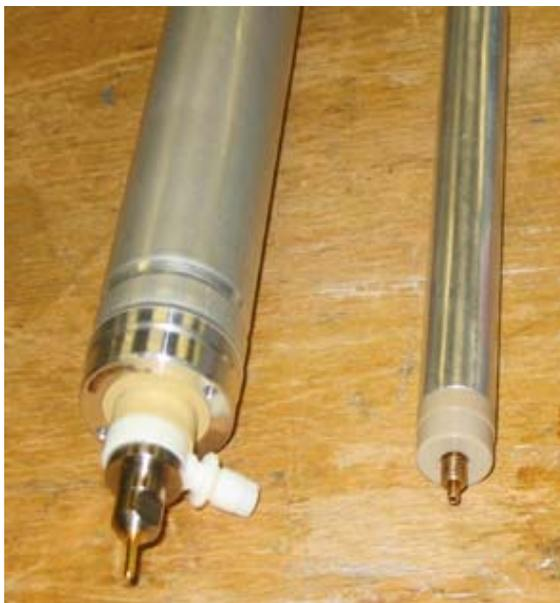
Рисунок 48 - Трубки диаметром 30 и 15 мм
