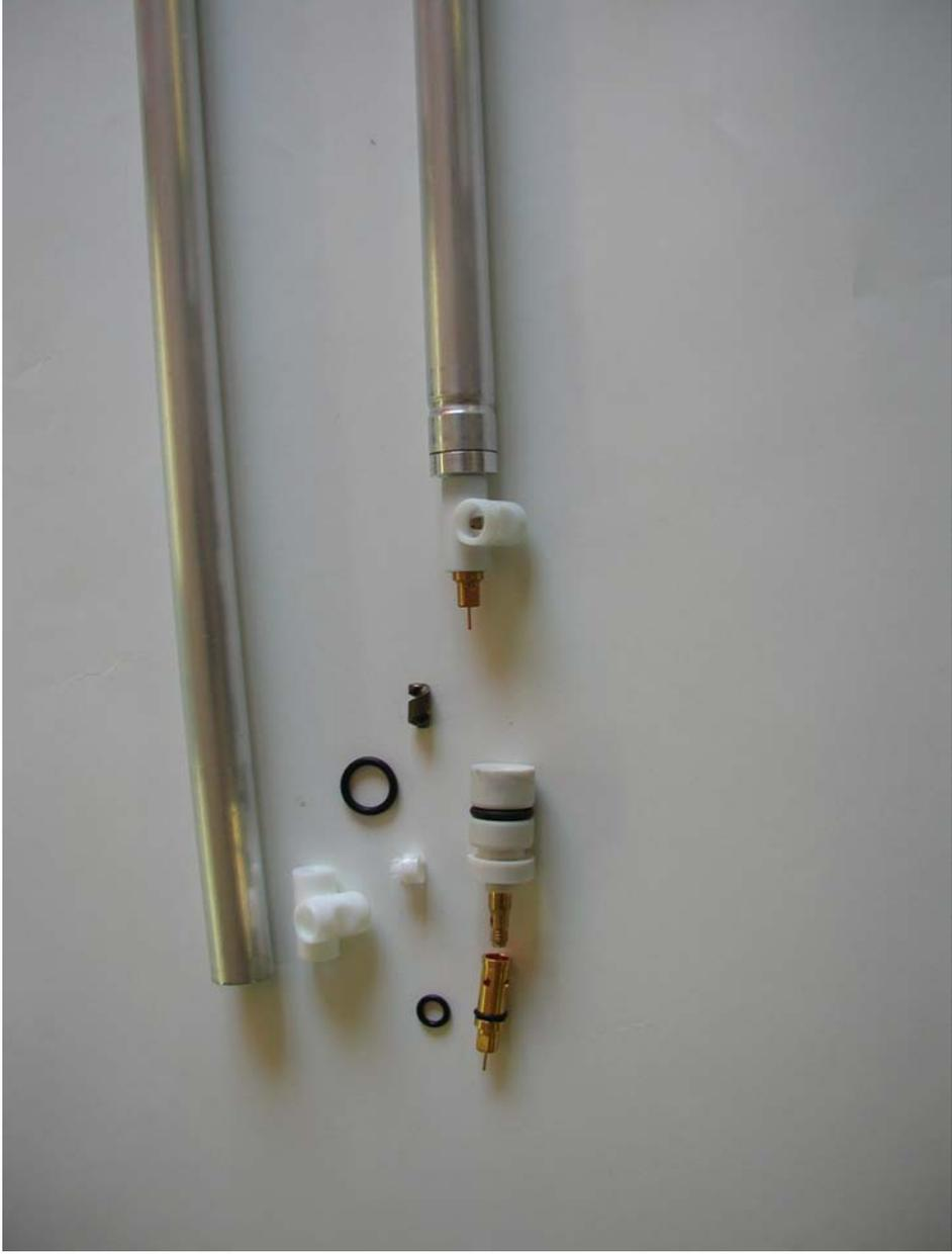
Фотография прецизионной дрейфовой трубки малого (15 мм) диаметра в собранном виде и ее отдельных компонент
