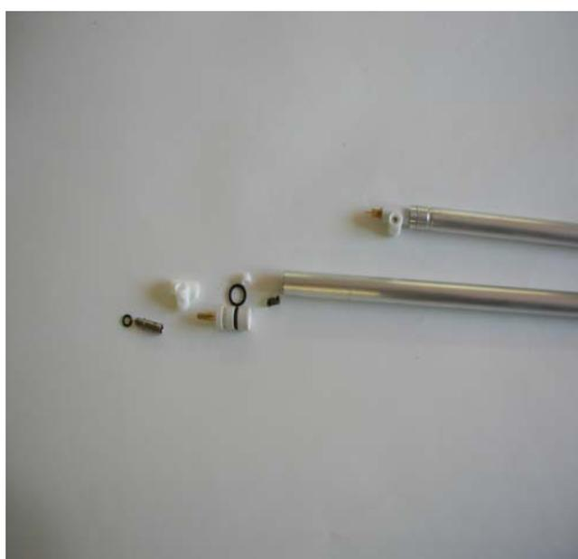
Рисунок 47 - Фотография 15 мм трубки в сборе и ее деталей
