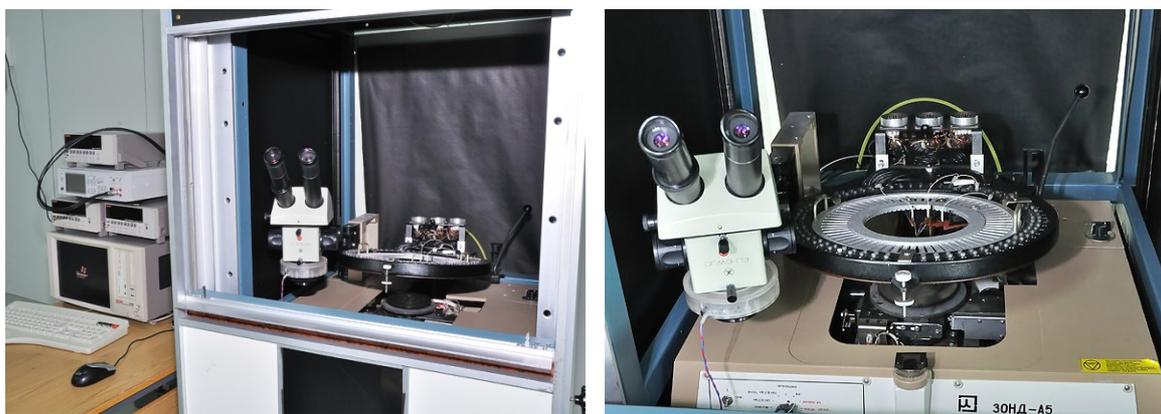
Рис. 3. Фотографии зондовой установки А-5.
