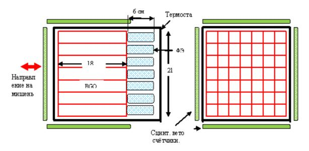
Рис. 6. Упрощённая схема электромагнитного калориметра на кристаллах BGO.
