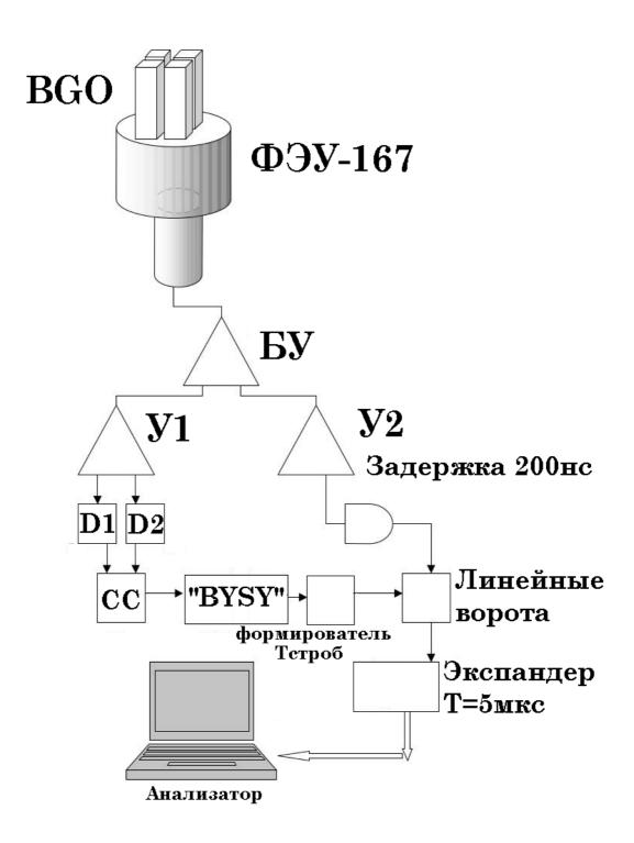
Рис. 1. Схема измерений. На рисунке для наглядности показана конфигурация с кристаллами, раздвинутыми на 2 мм.
