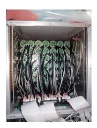
Рис. 10. Калориметр с откинутой задней стенкой. Внешний размер бокса ЭМК равен 287x287x420 мм<sup>3</sup>.
