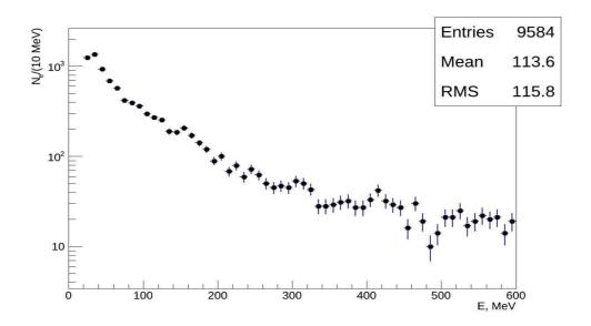
Рис. 14. Энергетический спектр, полученный в калориметре суммированием сигналов сборки счетчиков из 3х3 кристаллов. В спектр не внесены поправки на эффективность регистрации и на вклад от фотонов, рождающихся на конструкциях экспериментальной установки.
