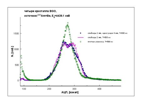
Рис. 2. Спектры сигналов от радиоактивного источника для разной упаковки кристаллов BGO.
