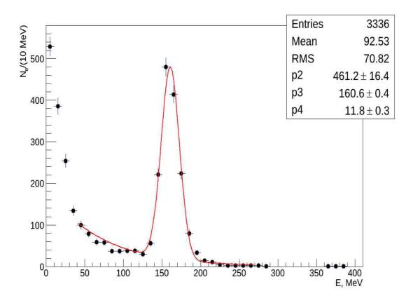
Рис. 13. Энергетический спектр в калориметре для событий, соответствующих пику во фронтальном охранном счетчике.
