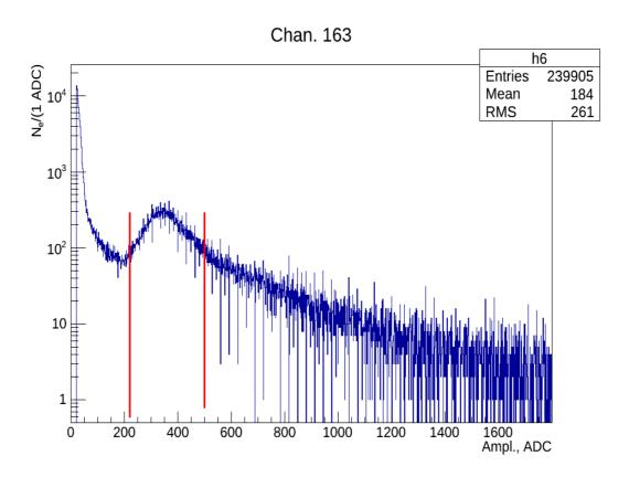
Рис. 12. Амплитудное распределение сигналов во фронтальном охранном счетчике.
