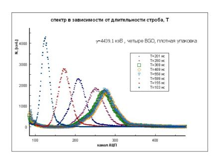
Рис. 3. Амплитудные спектры сигналов для разной длительности строба. Кристаллы плотно упакованы.
