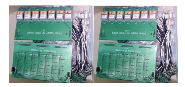
Рис. 8а. Лицевая сторона плат: вверху внешняя Рис 8б. Обратная сторона плат: На верхней плата – делители, внизу – внутренняя плата. Видны 49 разъемов для подключения панелей ФЭУ.
