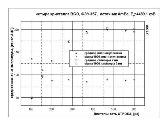
Рис. 5. Среднее значение амплитуды сигнала и его относительное среднеквадратичное отклонение (для масштабирования величина умножена на 1000) в зависимости от длительности строба.
