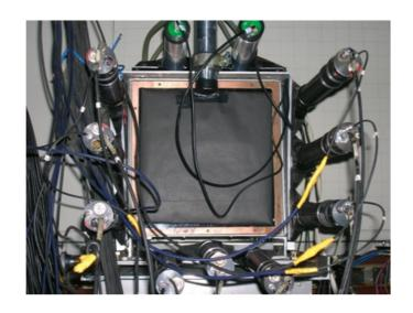
Рис. 11. Внешний вид калориметра в штатном положении.
