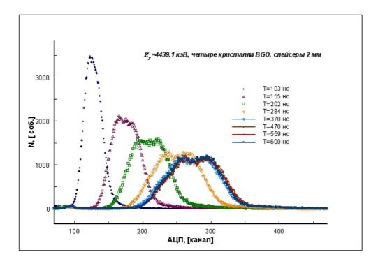
Рис. 4. Спектры сигналов для разной длительности строба. Между кристаллами установлены спейсеры 2 мм.
